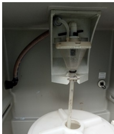
Vérification du canal de mesure et d'un préleveur installés au sein d'une entreprise
