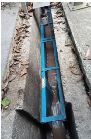
Vérification du canal de mesure et d'un préleveur installés au sein d'une entreprise
